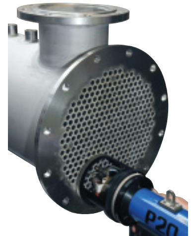
Automatisiertes Schweißen des Rohrendes und 100% Kontrolle.
