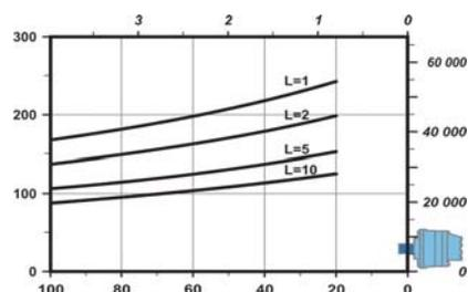
La duración de los componentes está condicionada por la presión. Es necesario asegurarse de que la combinación de las fuerzas aplicadas (carga axial / carga radial) es compatible con las cargas admitidas por los componentes, y de que la duración resultante está en conformidad con las especificaciones de la aplicación. Para realizar un cálculo preciso, consulte a su ingeniero de aplicaciones Poclair Hydraulics.
