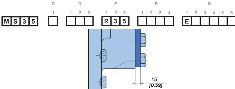
**G - Fijación especial de la llanta**
