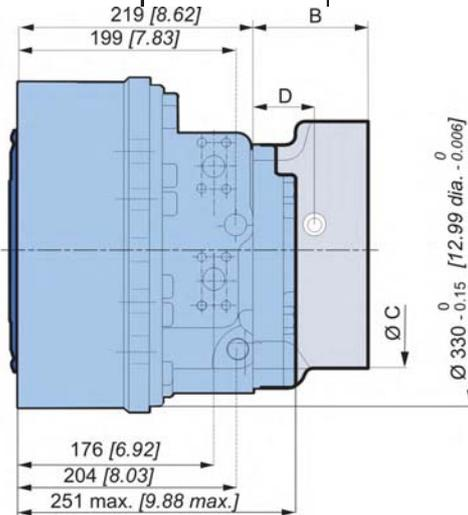
**Dimensiones de la distribución de Twin-Lock™ / 2 cilindradas (MS18)**
